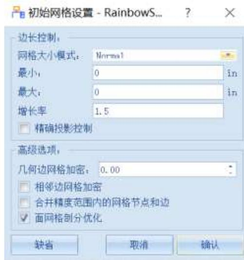
图 4-284 设置全局初始网格剖分控制参数
